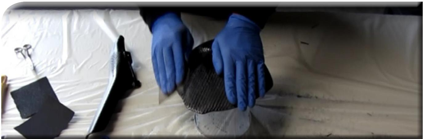
Nach dem Schleifen mit einem Staubsauger oder Druckluft vom Schleifstaub befreien und eine weitere Schicht Harz auftragen. Öffnungen oder Verschraubungspunkte, die von der Bauform her nicht mit Carbon bezogen werden können, sollten vor dem Klarlackauftrag mit einer Klinge oder geeignetem Werkzeug befreit und verschliffen werden.
