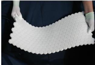
3D|CORE ist flexibel. Die kleinen Brücken zwischen den Schaumkörpern von 3D|CORE sind das Merkmal, welches den Schaumkern flexibel macht. Weder Wärme-, Gewichts-, oder Vakuumverformung sind erforderlich um den Schaumkern an die Form anzupassen. Das spart Zeit und Energie. Um sicherzustellen, dass der Kern in der Form in der gewünschten Position bleibt, verwenden Sie einen Sprühkleber, welcher für Ihr Epoxidharz geeignet ist.
