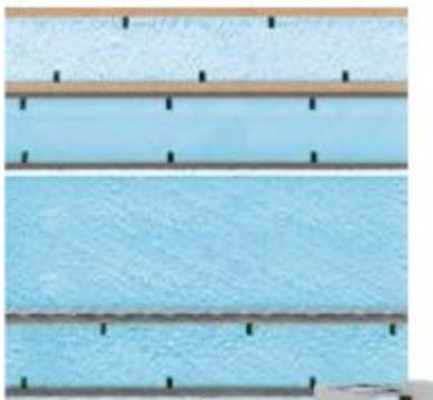
Bei handelsübliche Schaumkerne wird eine Behandlung der Oberflächen empfohlen, um die Sekundäranbindung zu verbessern. Die empfohlenen Rillen von 2x3 mm alle 50 mm auf einer Länge von 1000 mm führen zu einer bemerkenswerten Harzaufnahme im Bauteil.
