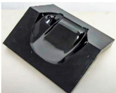
Nach dem Ausformen können Sie die Form besäumen und falls nötig auf Hochglanz polieren. Dazu sollten silikonfreie Poliermittel verwendet werden. Kleine Fehler in der Oberfläche können mit etwas Gelcoat gefüllt und durch einen aufgeklebten Streifen Tesafilm geglättet werden. Anderweitige Fehler können auch mit Schleifpapier (Korn 600 bis 2000) bearbeitet werden. Bei Schleif- und Polierarbeiten sollten Sie darauf achten, keine punktuelle Hitze zu erzeugen.
